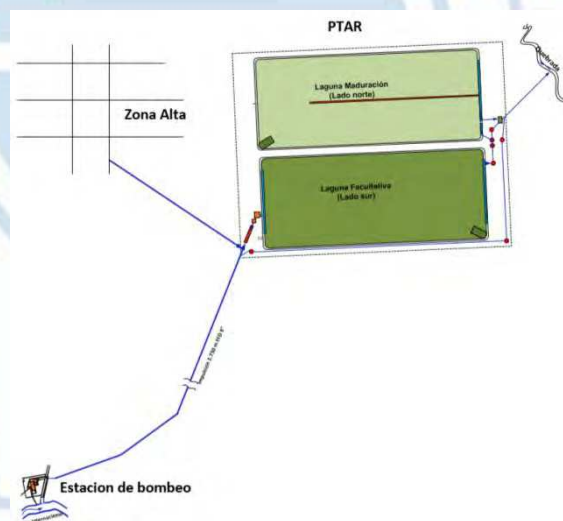
Figura 7 Planta de tratamiento de aguas residuales Villazón
